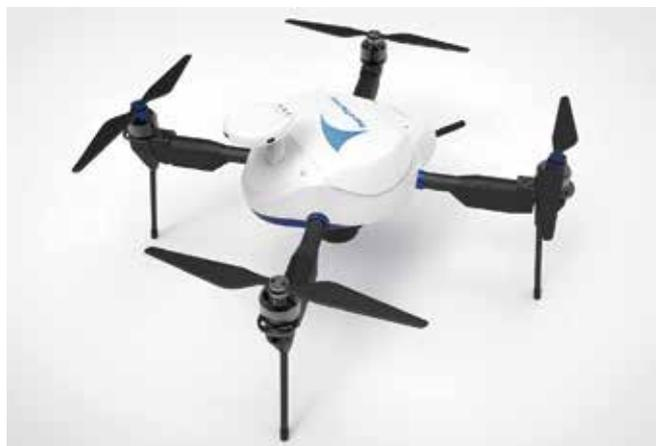
今回提供を開始するフライトサービスは、有線給電ドローンと4K対応カメラを組み合わせたライブ撮影サービス。ドローンへの給電を有線で行い、同じケーブル内で映像も伝送することで、約6時間の長時間連続飛行をしながら、4K高画質のダイナミックな空撮映像をほぼ遅延なく伝送することが可能。また、本サービスには、撮影機材の提供に加え、ドローン操縦や、飛行に必要な申請を行うオペレーターの派遣も含まれている。操縦や申請といった専門知識が必要な部分をすべてオペレーターに任せられるため、ドローン撮影の技術や知見のない人でもドローン空撮をビジネスに活用できる。近年、さまざまな用途で、ドローンを活用した撮影が行われるようになってきた。しかし、一般的な無線ドローンによる撮影では、連続飛行時間が20分程度と短いことに加えて、映像の伝送時に画質を下げる必要があったり、遅延が生じたり
