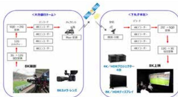
8K映像の伝送実験フロー（イメージ）・実験実験の様子
