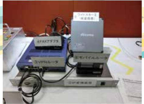
写真5 通信系の展示では、熊本地震を契機に開発が進められたという衛星回線（ワイドスター）を用いた簡易監視・制御装置が関心を呼んだ。
