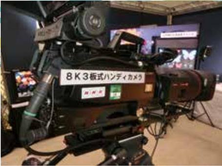
写真3 番組制作のステージの目玉は、世界初 1.25 型マウント 8K 4:2:2 3 板式 CMOS ハンディカメラであった。
