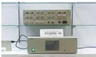
長距離伝送器機製品のコーナーでは、4K 対応スロット型マトリックススイッチャー「KS1208SL-00」(写真上)を中心に、新製品 HDMI/アナログRGB対応 ツイストペアケーブル延長送信機「KE201ST」、4K 対応ツイストペアケーブル分配延長器「KE102CS」などを紹介。「KS1208SL-00」は、入力 5 種類、出力 4 種類の専用ボードを組合せる事でアナログRGB から HDMI (4K/30Hz)、3G-SDI まで幅の広い映像信号に対応することができる。スロット型マトリックススイッチャー。専用ボードは 2 系統入力/1 ボード、2 系統出力/1 ボードとなっており、入力最
