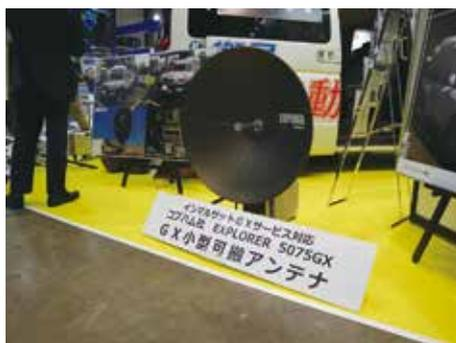
I-4 衛星の L 帯リンクとを組み合わせることで高い稼働率を確保する。通信速度は、上り最大 5Mbps、下り最大 50Mbps。サービス地域は、極地を除く全球としている。
