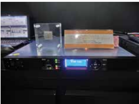
写真2 「4K映像符号化技術」のコーナーには、1Uに仕上がった4Kハイフレームレート120p HEVCエンコーダが展示された。
