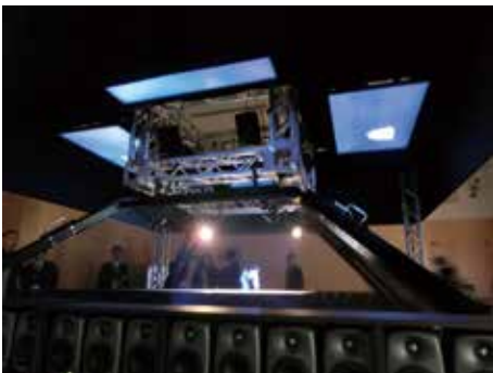
写真1 「競技空間を取り囲む新しい視聴体験」のコーナーでは、プロジェクター、反射鏡、透明スクリーンを駆使して3D映像を結像させ、スピーカアレイで波面合成音響を実現していた。
