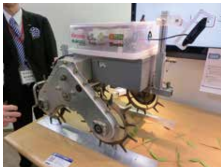
写真4 作物を踏まないで雑草の除草と生長の抑制に役立つという「畑作用AI除草ロボット」の試作品が公開された。
