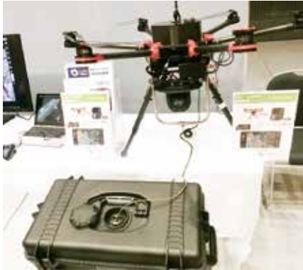
日本海洋㈱：ドローン向け有線給電システム
