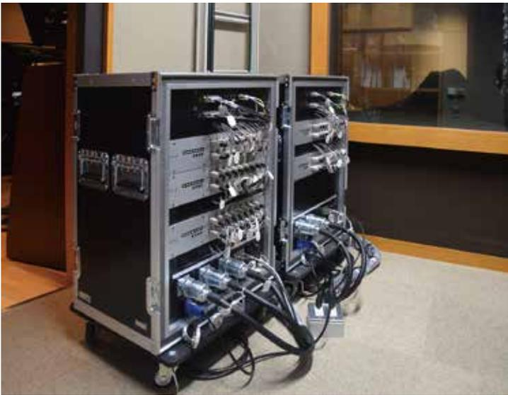
2式のステージボックスは、ビル内2階のコンサートホール収録時には1式は2階に降り、繋がれる
