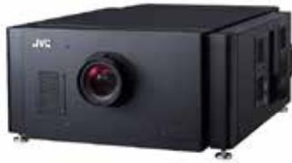
に加え、レーザー光源技術「BLU-Escent」(ブルーエシセント)を搭載し、「D-ILA」ならではの高精細・高コントラストとレーザー光源技術による高輝度かつ長寿命を実現。高解像で臨場感ある映像表現と低ランニングコストを両立したプロジェクターとして、業務用途向けに提案していく。
