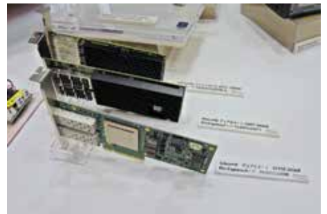
【Silicom】(上から) PE310G4SPI9LA クワッドポート SFP+ 10GbE PCI Express カード、PE340G2QI71 デュアルポート QSFP 40GbE PCI Express カード、PE325G2DS1R デュアルポート SFP28 25GbE PCI Express カード
