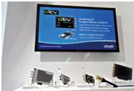
【DekTec】写真左から右へ DTA-2195 12G-SDI 入力+出力 / HDMI2.0 出力 PCI Express カード、DTA-2162 デュアル GbE PCI Express カード、DTA-2174 クワッド 3G-SDI/DVB-ASI 4K 対応入出力 PCI Express カード、DTU-315 USB-3 ユニバーサル・マルチスタンダードモジュール、DTA-2179 x12 3G-SDI/DVB-ASI 4K 対応入出力 PCI Express カード
