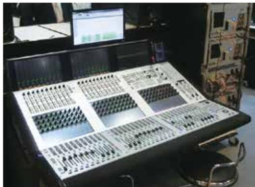
▲フラッグシップモデル「VISTA X」(ビスタエックス):Vistonics (ビストニクス)を核とする世界で最もわかりやすいデスク表面はそのままに、CPUベースの音声処理部InfinityCore (インフィニティコア)を新開発。その圧倒的な音声処理能力により、増え続ける
