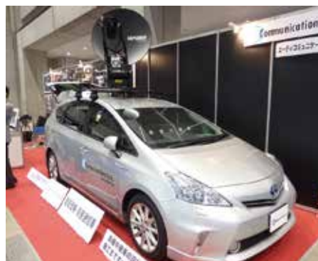
▲トヨタ・プリウス衛星中継車：衛星自動補足機能を備えるEXPLORER COBHAM アンテナを装備
