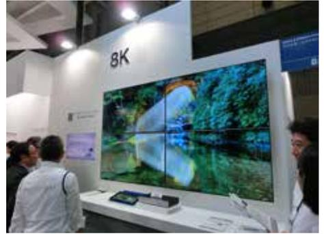
写真5 ソシオネクストは、同社製LSIを組み込んだリアルタイムデコーダを使って、4面マルチスクリーンで8K 60p映像を再生して見せていた。
