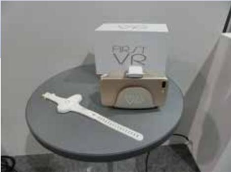
写真3 H2L社は、軽くてコンパクトなHMDと筋変位コントローラーを組み合わせたVRシステムを紹介し注目を集めた。
