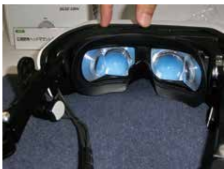
写真1 パナソニックは、4Kレベルの解像度、220度の広視野角を誇るVR HMDの試作品を公開して注目の的になった。
