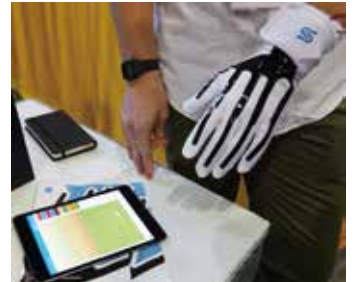
図11 Stretchsense社の伸縮するセンサーを用いた手袋
