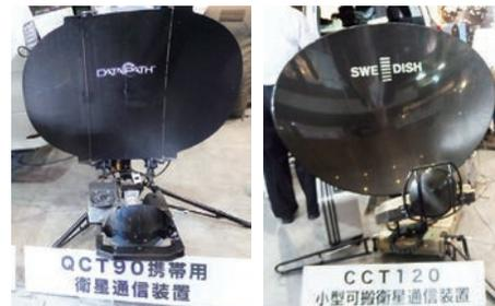
QCT90携帯用衛星通信装置 CCT120 小型可搬衛星通信装置
