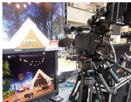
カメラステージには新製品「UHK-430」を出品。2/3型4K CMOS 3板式カメラシステム「UHK-430」は、HDカメラと同様の運用性で、4K映像制作を実現しており、新開発2/3型4K CMOSセンサー3板式の光学系を搭載。現行HDカメラと同じB4レンズマウントを採用することで、これまでと変わらない操作感での4K映像制作が可能。新開発の次世代高速ビデオプロセッサ「AXII」を搭載。High Dynamic Rangeに対応したカスタムガンマ機能搭載。センサユニット部が分離可能な構造により、フレキシブルな運用を実現。カメラ/CCU間の伝送路は40Gbpsの超広帯域を確保し、RGB 4:4:4の4K非圧縮信号伝送を実現している。
