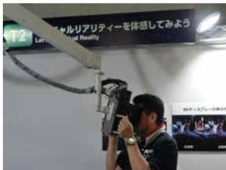
写真4 VRシステムの体感コーナーでは、世界最小8.3インチの8K有機ELディスプレイを用いたVRシステムのプロトタイプが人気を呼んだ。
