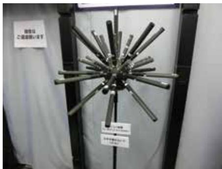
写真3 「音響用デバイス」のコーナーでは、指向性マイクロホンと指向性改善補助マイクロホンを組み合わせた22.2チャンネル音響ワンポイントマイクロフォンが注目を集めた。
