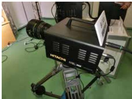
写真2 「撮影・記録技術」のコーナーでは、8K映像を4倍速で撮影し記録することができる8Kスローモーションシステムの実験機が紹介された。
