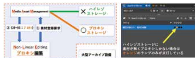
図4 ワークフロー説明（ハイレゾストレージに素材が無い場合） ハイレゾストレージに素材が無い場合、編集者に対して② プロキシがある旨を通知し、プロキシによる編集が可能になる。
