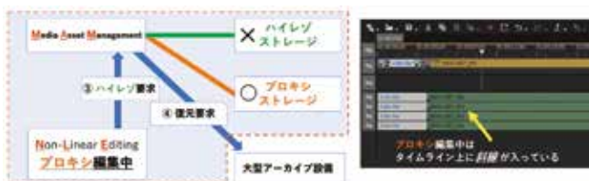
図5 ワークフロー説明（ハイレゾストレージに素材が無い場合） 編集者がプロキシで編集、③ 編集ソフトはMAMに対して大型アーカイブ設備に保存されているハイレゾをハイレゾストレージへ復元するための要求をバックグラウンド処理で行う。そして、④ MAMが大型アーカイブ設備に対して、ハイレゾストレージへ復元するよう要求する。
