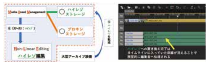
図6 ワークフロー説明（ハイレゾストレージに素材が無い場合） ④の要求を受けた大型アーカイブ設備は、⑤ハイレゾストレージに対して素材を転送し、転送が完了すると⑥ MAMが編集ソフトに対してハイレゾのステータスになったことを通知することでプロキシ編集中の映像がシームレスにハイレゾへ切り替わり、ハイレゾ編集ができるようになる。
