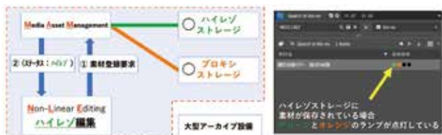
図3 ワークフロー説明（ハイレゾストレージに素材がある場合） 編集者は、必要な素材を検索・特定するために管理システム（Media Asset Management）へアクセスする。MAMは素材に関するあらゆる情報を管理しており、ハイレゾやプロキシ、映像内容に関するメタデータ、映像の物理的保存場所に関する情報が保存されている。 素材を検索・特定すると、編集者は①「素材登録要求」を行う。MAMは保存されている素材がどのような状態（ステータス）なのかを確認し、ハイレゾストレージに素材が保存されていれば、編集者に対して② ハイレゾがある旨を通知し、直ちにハイレゾによる編集が可能になる。
