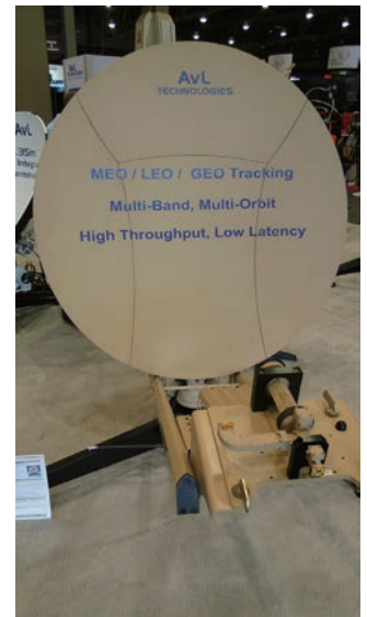
写真4 AvLテクノロジーズ社は、低軌道周回、中軌道周回、静止衛星をトラッキングできるというマルチオービット、マルチバンド可搬局を紹介して話題になった。
