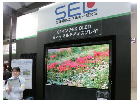
写真4 半導体エネルギー研究所は、額縁部を透明化した81インチ8K OLEDマルチディスプレイを披露して来場者を魅了した。
