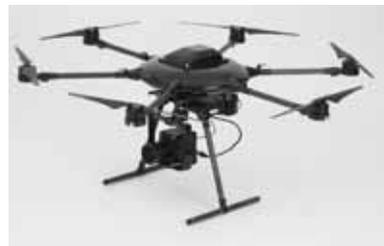
これまで夜間などの低照度環境下では赤外線投光によるモノクロ撮影が一般的だったが、「ME20F-SH」は肉眼で被写体の識別が困難な暗闇でもカラーフルHD動画の撮影が可能のため、夜間でも上空から被災状況を撮影することができる。全天候型の機体性能にあわせカメラ部も全天候型のハウジング構造にするなど雨天等の悪環境でも使用できる設計となっている。また、遠隔地通信機能も備えており、飛行しながらリ
