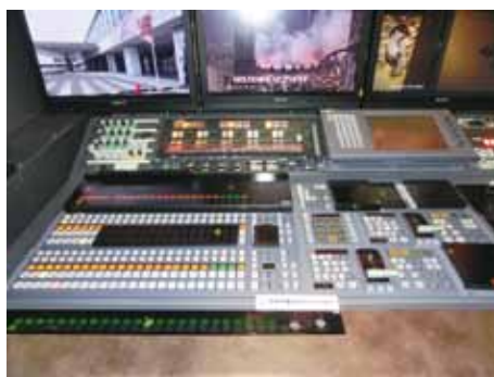
写真2 「SHC-2」には、新規開発したという8K4:2:2にも対応するIP入力インターフェースを備えた映像スイッチャーが搭載されていた。
