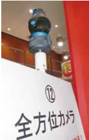
写真3 3個の魚眼レンズ（各120度）を搭載したフランスのGiroptic社製の全方位カメラが紹介され注目を集めた。
