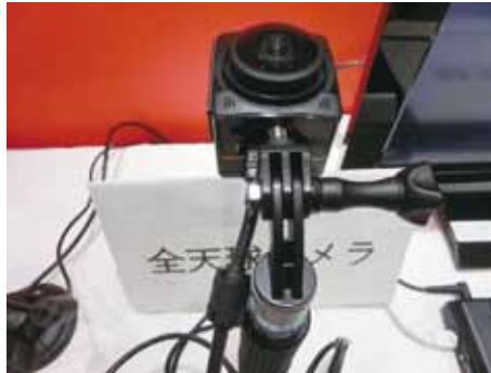
写真4 コダック社の4Kアクションカム「PIXPRO SP360」で撮影した全天球映像から任意の位置とサイズを切り出して出力するシステムも紹介された。
