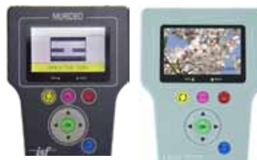
HDMI2.0、4K対応ジェネレータ「Fresco SIX-G」(左)とアナライザ「Fresco SIX-A」
