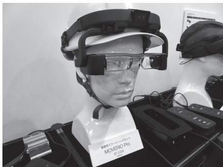
写真1 初出展のセイコーエプソンは、ポリシリコンTFTアクティブマトリックス方式のヘッドセットモデル「BT-2000」と同ヘルメットモデル「BT-2200」を展示して注目を集めた。
