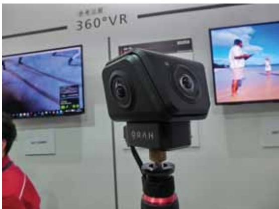
写真1 キヤノンは、4台の魚眼レンズ付きカメラと4個のマイクを組み合わせた360度VR撮影システム「Orah 4i」を出展して注目的になった。
