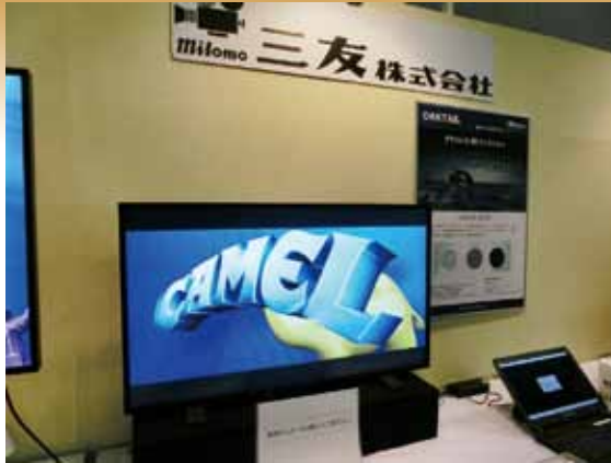
写真3 三友は、レンチキュラー方式による広視野角ガラスレス4K3Dディスプレイ「OAKTAIL 4K」のデモを行って注目を集めた。
