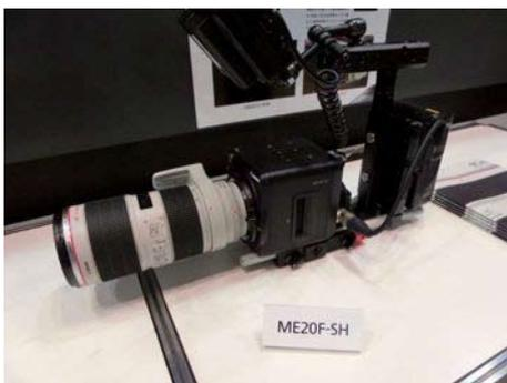
写真1 キヤノンは、超高感度多目的カメラ「ME20F-SH」を出展して、被写体照度が0.0005ルクス以下と強調した。
