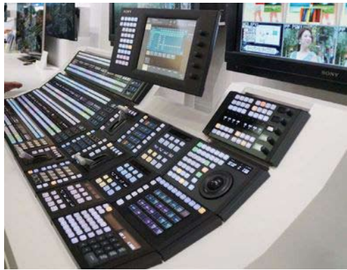
写 19: NMI を装備した IP ライブスイッチャー“XVS7000”
