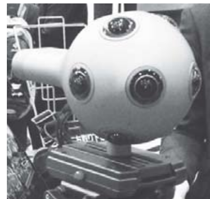
Nokia 製リアルタイム 360度 VR カメラ「OZO」 「OZO Remote」で撮影したものをリアルタイムでモニタリングでき、VR 上で再現できる。
