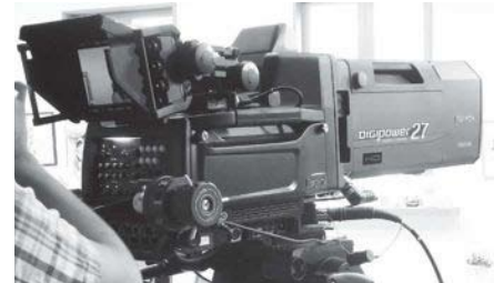
「UHK-430」に装着されたシステムエクスパンダ「SE-U430」
