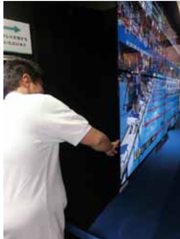
写真4 NHK/JEITAは、2ミリという極限の薄さを誇るシート型ディスプレイによる8Kコンテンツの上映を行って耳目を集めた。
