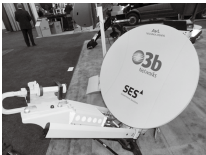
写真3 AvLテクノロジーズ社は、O3bネットワーク社のKaバンド周回衛星をシームレスに追尾できる可搬局を披露した。
