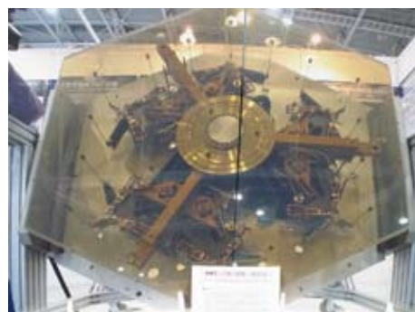
写 19. 超高精密な主鏡の一枚の試作品
