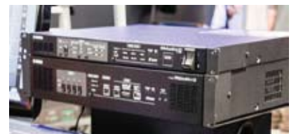
▲ 「RSio64-D」はDANTE からの変換器で、最大で64IN 64OUT のDANTE ⇄ MADI 変換に対応した「RSio64-D」
