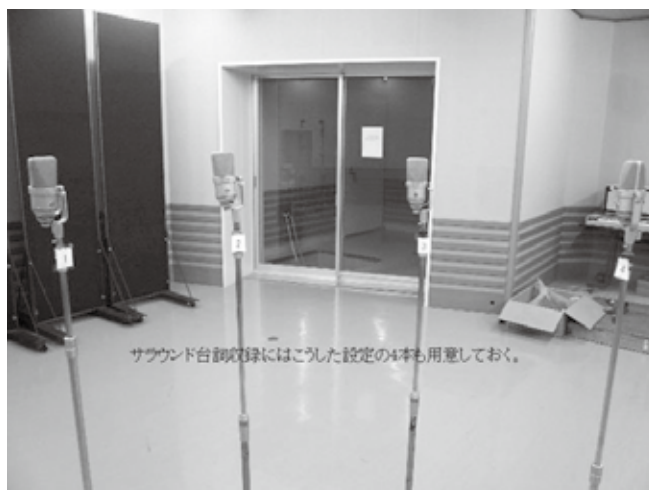
写真8 正面LR、後方LRの4本のマイクロフォンでサラウンド収録
