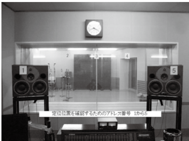
写真4 調整室での定位ポジション、アドレスを確認しながら収録作業を心がける
