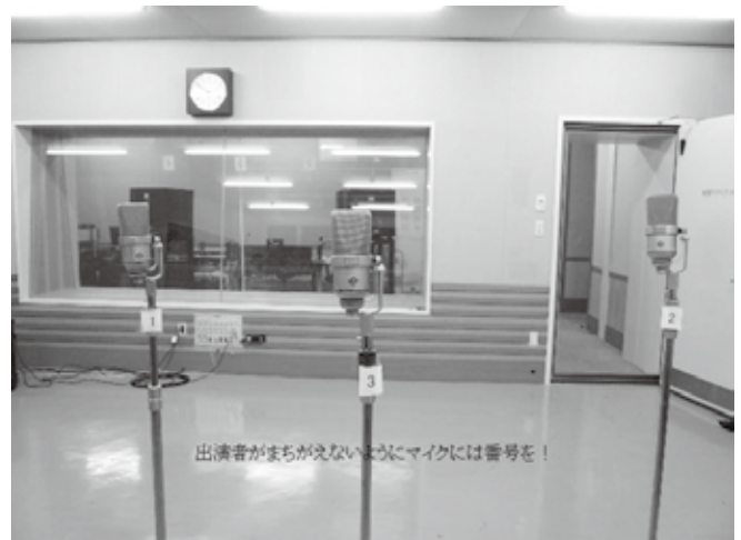
写真 3 ステレオでの台詞収録にセンター定位用マイクロフォンを追加した例
