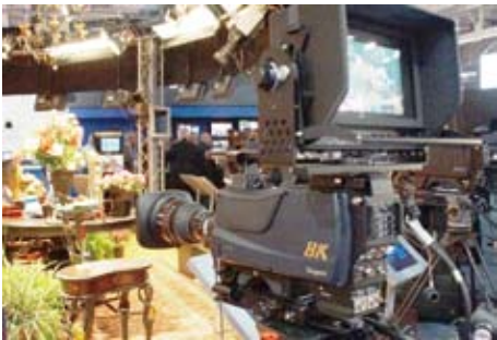
写 18. 小型軽量のポータブル型 8K カメラ
