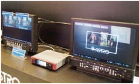
写 28. HD 放送でも使える 4K 切り出し装置
