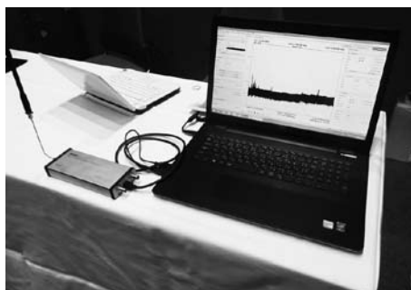
不審な電波を瞬時に探査、テロリストや過激派などの活動を調査する「不審電波簡易型探査装置」
