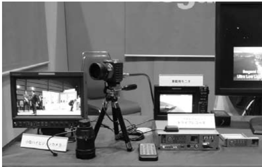
捜査用小型ハイビジョンカメラシステム: 小型ハイビジョンカメラ、車載用モニタ、ドライブレコーダなどによる構成。
