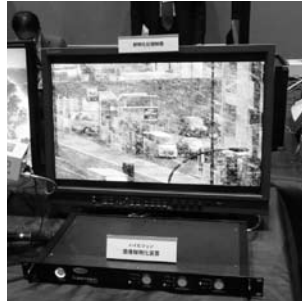
HD 画像鮮明化装置: 霧やモヤなどの気象条件でも最新の画像処理技術により、撮影場所の状況を確認できる。
