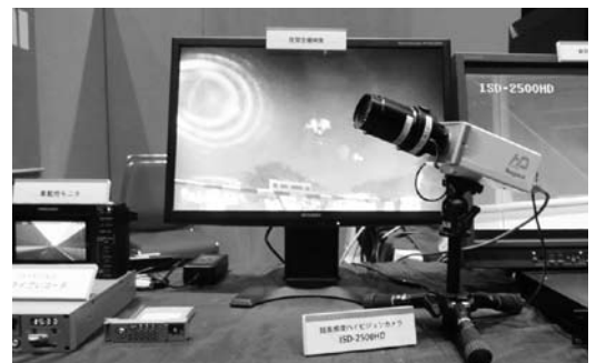
ISD-2500HD: 昼夜を問わず鮮明なハイビジョン映像で確認できる。夜間では、星明り程度の明るさでもフルカラー映像、フル動画撮影が行える。夜間の災害現場の状況や停電した場所の撮影が可能のため、即座に現場状況を確認し、対応することが可能。NTSC出力も搭載。既存のシステムにも接続できる。
