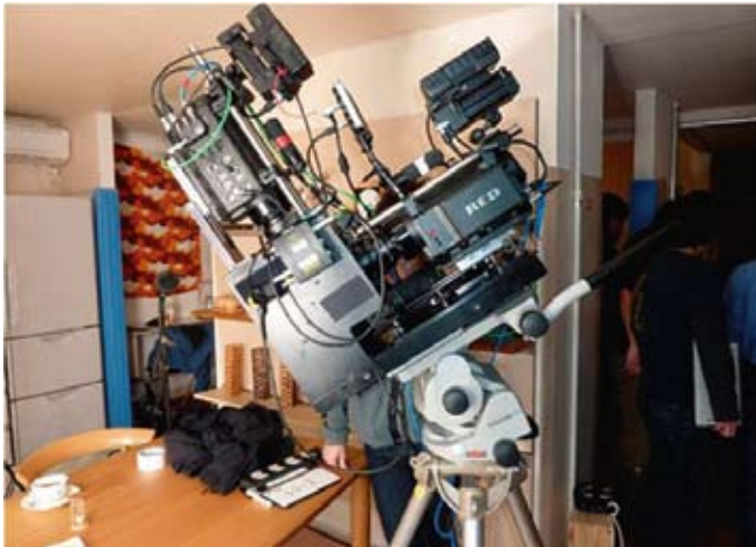
図 15 超高精細ステレオ三次元映像コンテンツ制作で使用された 4K 立体 3D カメラ撮影システムの外観 (出典：NHK メディアテクノロジー 村山至氏プレゼン資料)
