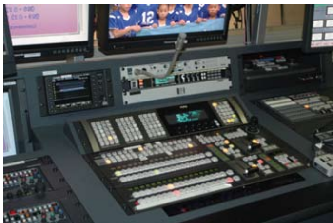
スタジオサブのスイッチャは朋栄の 2M/E モデル花火 HVS-3800HS で、DVE x 2、バーチャル対応機能を搭載
