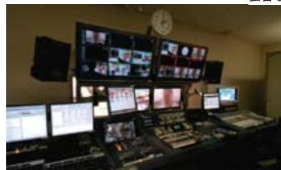
スタジオサブのモニターはマルチビューアで各映像を確認しながら送出している。バーチャルセットの運用端末からはセットや項目を簡単に変更・切り換えることが可能
