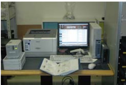
MediaConcierge のアーカイブシステムはマシン室に設置され、スタジオ番組を生放送と同時に送出サーバーにて同録し、オンエア終了後にBlu-rayへアーカイブする
