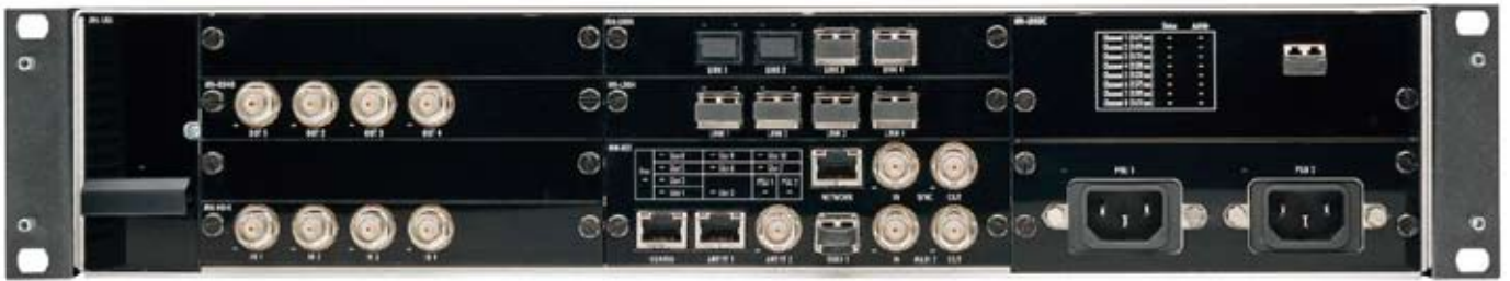
メインフレームの Mediomet-A モジュラーシステム 中央下半分はプロセッシングカード部分
