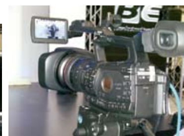
"XF305"は、同社の業務用ビデオカメラで初めてMPEG2フルHDでのファイルベース記録形式を採用しており、映像記録媒体はCF(コンパクトフラッシュ)内蔵の設計となっている
