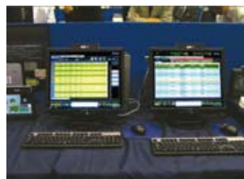
最大8chの送出が可能な自動番組送出装置"Ocris" (オクリス) の表示画面
